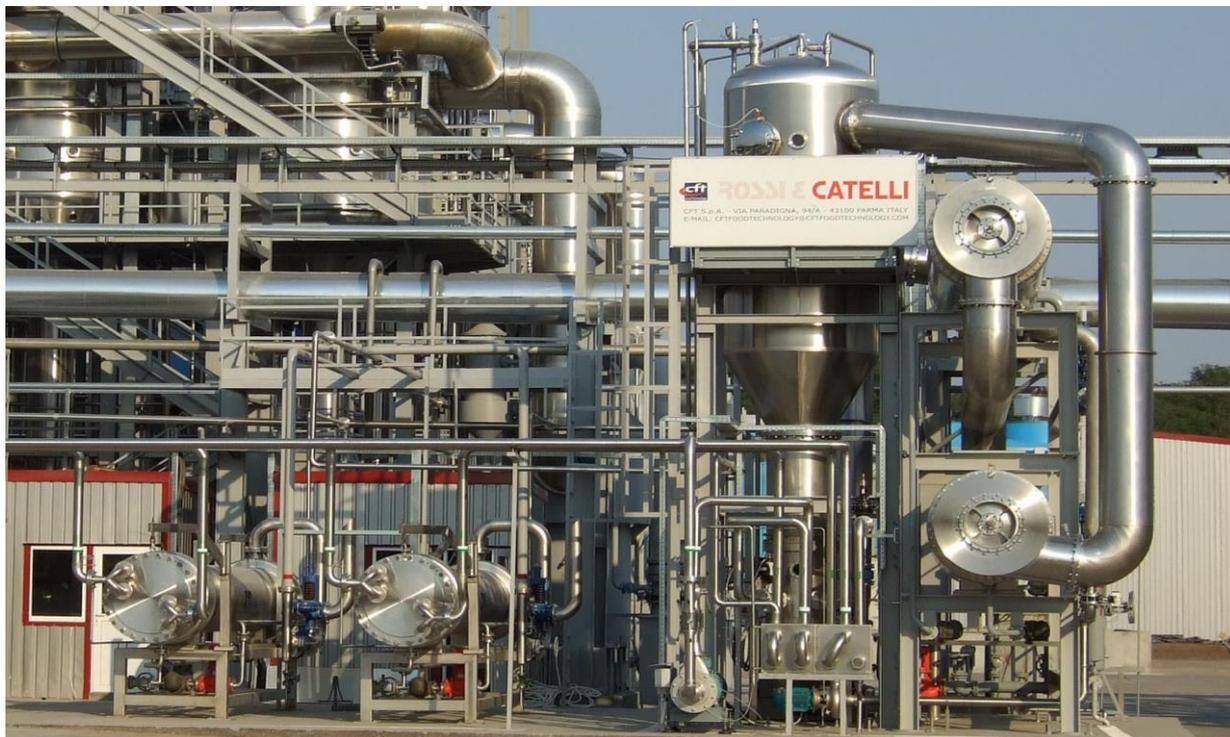
Из систем СВ и НВ томатная масса поступает на протирку в группу Giubileo с использованием двухкорпусной системы. В первом корпусе идет предварительная протирка (сита с отверстиями 1,2-1,5 мм для СВ и НВ), а во втором – рафинирование (сита с отверстиями 0,6 мм для СВ и 0,8 мм для НВ).
