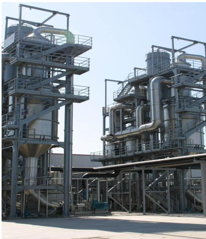
Выпарная система Venus – это 3-ступенчатая система выпарная станция с принудительной циркуляцией для доведения продукта до желаемой окончательной концентрации BRIX 25-28-30 для томатной пасты СВ и BRIX 36-38 для томатной пасты НВ.
