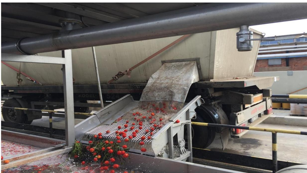
Томаты с потоком воды попадают на разделительную решетку, по которой падают в последующий канал для предварительной мойки и транспортировки, а вода, используемая для вымывания из грузовиков, через решетку отделяется и поступает на водоочистительные системы оборотной воды.
