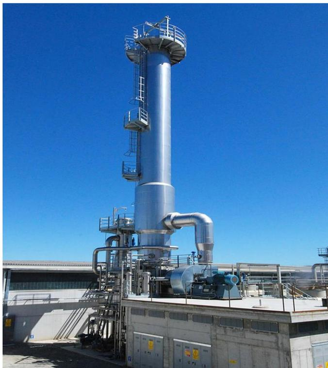
Выпарная станция Apollo с очень большой эффективностью производит удаление половины содержания воды (40-50 тонн/час) из томатной пасты.
