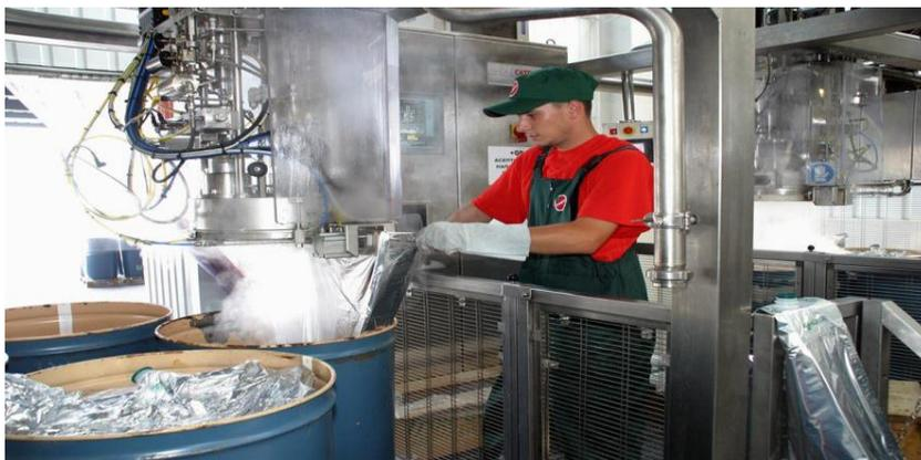
Концентрированная томатная паста упаковывается в 200-литровые асептические мешки (примерно 230 кг), вставленные в конические металлические бочки (Bag in drum) для удержания формы и защиты от механических повреждений. В таком виде томатный концентрат можно хранить в течение 2-х лет.
